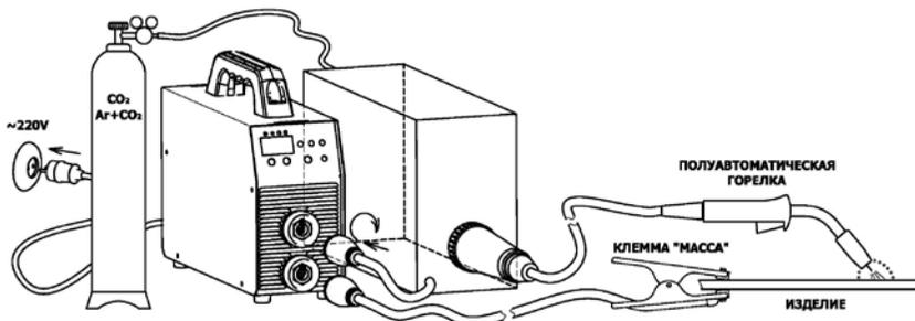
**Внимание!** В качестве защитного газа применяется при сварке чёрных металлов в простейшем случае углекислый газ "CO<sub>2</sub>", а при сварке алюминия только инертные газы типа аргон "Ar", иногда дорогой гелий "He", как альтернатива для нержавеющей и высоколегированных сталей часто применяются смеси в различных пропорциях "80%Ar+20%CO<sub>2</sub>". Использование других газов только по согласованию с производителем оборудования.
