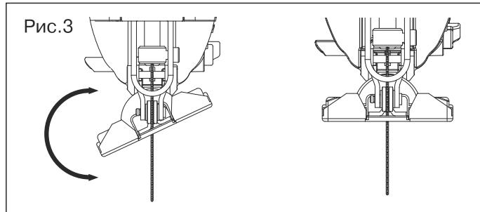
Отпустите винт **12** и сместите опорную подошву **4** слегка в направлении патрубка отвода стружки **3**. Для настройки точного угла наклона опорная плита оснащена слева и справа точками фиксирования для значений в 0°, 22,5° и 45° (См. рис. 4). Поверните опорную подошву **4** в соответствии со шкалой **13** в желаемое положение. Затем сместите опорную подошву **4** в направлении пильного полотна **6** до упора.
