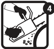
Рис.3: 4 Правильне положення рук на електропилці при роботі з пилою.
