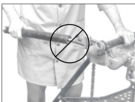
**Не используйте** – ключ в качестве молотка. Трубный ключ предназначен для захвата труб. Использование в качестве молотка может повредить ключ.
