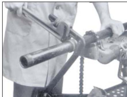
При использовании ключа RapidGrip, расположите деталь по центру в “V” верхней щеки. Если деталь не соприкасается с обеими сторонами “V”, это может ослабить захватывающее действие ключа и произойдет поломка щеки.
