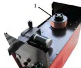
Мал. 8: Встановлення котушки з дротом
