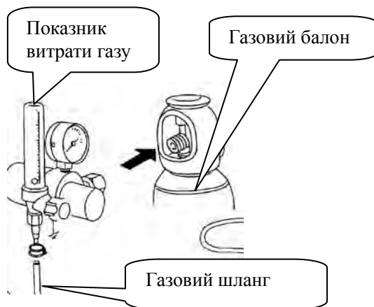
Мал. 5: Підключіть шланг газ і газовий балон
