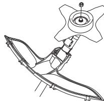
Встановлюючи ріжучу насадку, затягуйте гайку в бік, протилежний напрямку обертання насадки. Щоб зняти насадку, відкручуйте гайку в бік обертання. (УВАГА! Гайка має лівобічну нарізку.) Затягніть гайку, використовуючи торцевий гайковий ключ.
