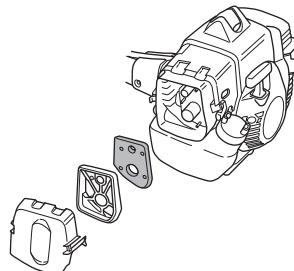
Прочищайте фільтр через кожні 25 годин роботи, а при роботі в місцях, де багато пилу, і частіше.
