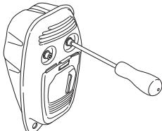
Якщо глушник інструменту обладнано іскропоглинаючою сіткою, її слід регулярно чистити. Забруднена сітка приведе до перегрівання двигуна, що може спричинити серйозне його пошкодження.
