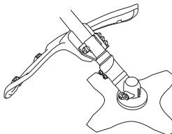
Перевірте, чи кожух не пошкоджений та чи на ньому немає тріщин. Замініть кожух, якщо він зазнав удару або має тріщину.
