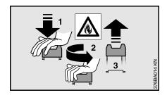
Ни в коем случае не открывать и не закрывать байонетный затвор крышки топливного бака с помощью
