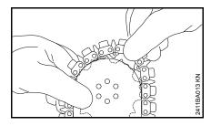
Установить алмазную абразивноотрезную цепь, начиная с верхушки шины
