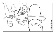
Работать вдоль разделительной линии. При корректировках алмазную абразивно-отрезную цепь не перекашивать, а всегда устанавливать заново
