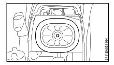
• Снять воздушный фильтр
