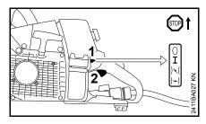
Нажать и сразу же отпустить рычаг газа (2), комбинированный рычаг (1) переходит в рабочее положение I, а двигатель переключается в режим холостого хода.
