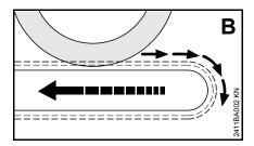
Если при абразивно-отрезной резке верхней стороной направляющей шины – задний рез – алмазная абразивно-отрезная цепь защемляется или наталкивается на твердый предмет, то устройство для резки камня может резко отбросить в сторону пользователя.
