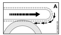
Если при абразивно-отрезной резке нижней стороной направляющей шины – передний рез – алмазная абразивно-отрезная цепь защемляется или наталкивается на твердый предмет, то устройство для резки камня может резко повести в сторону разрезаемого предмета.
