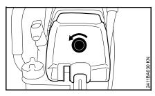
Заглушку над задней рукояткой повернуть по часовой стрелке и снять крышку фильтра – нетеряемую резьбовую заглушка закрепить в крышке фильтра
