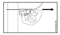
Следить за тем, чтобы в расширенной зоне поворота алмазной абразивно-отрезной цепи не находились части тела.
