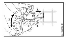
Направляющую шину установить нижней стороной верхушки шины
