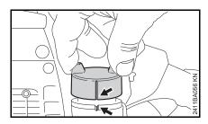
Взяться за крышку бака – крышка зафиксирована правильно, если ее нельзя снять и маркировка (стрелки) на крышке и топливном баке совпадают
