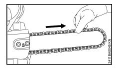
Проверить натяжение алмазной абразивно-отрезной цепи – алмазная абразивно-отрезная цепь вручную натягивается на направляющую шину
