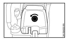
Заглушку над задней рукояткой повернуть по часовой стрелке и снять крышку фильтра – нетеряемую резьбовую заглушка закрепить в крышке фильтра
