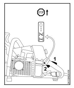
Стопор рычага газа (2) и рычаг газа (3) нажать одновременно и оба рычага удерживать нажатыми – отрегулировать комбинированный рычаг
