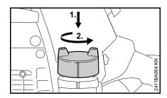
Крышку бака отжать рукой вниз до упора, повернуть против часовой стрелки (около 1/8 оборота) и снять.
