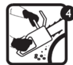
Рис.3:4 Правильне положення рук на електропилці при роботі з пилкою.
