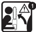
Рис.3: 1,2 Забороняється працювати кінцем шини!
