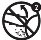
Рис.3: 1,2 Забороняється працювати кінцем шини!
