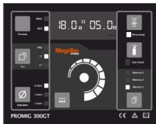
Рисунок 6: Проверка подачи проволоки в режиме MIG
