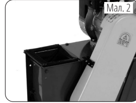
Прилаштування прокладки бункера
