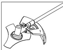
Захисний кожух повинен кріпитись до опорної частини біля привода, за допомогою 4 гвинтів та двох пластин.
