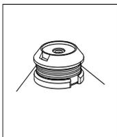
Прикрутіть нейлонову насадку проти годинникової стрілки (в леву сторону) по різьбі штока в кінці приводної частини. Зафіксуйте шток на місці, вставив викрутку або шестигранний ключ в отвір в верхньому затискачі насадки та щільно затягніть гвинт.
