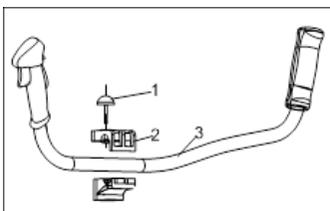
Встановіть ручку в спеціальну скобу. Затягніть скобу для ручки за допомогою 4 кріпильних гвинтів, що поставляються в комплекті. Прикріпіть ручку на шток в зручному робочому положенні, потім щільно затягніть кріпильні гвинти.
