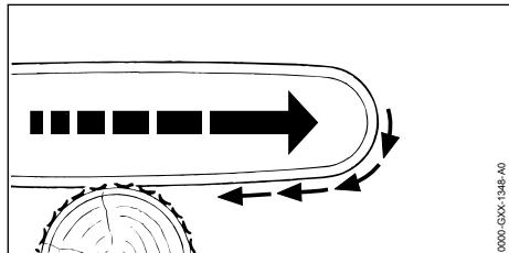
Якщо робота виконується нижньою стороною направляючої шини, висоторіз відтягується від користувача.
