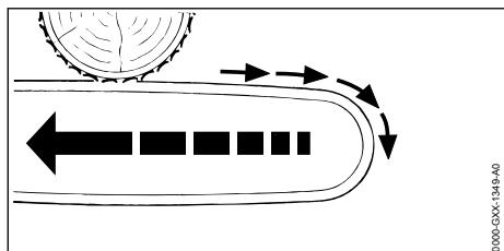
Якщо робота виконується верхньою стороною направляючої шини, висоторіз тисне у напрямку користувача.
